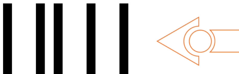
Un codice a barre che attiva il programma inseguimento linea di Edison
