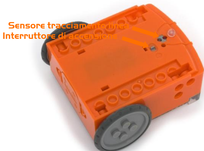
Interruttore di accensione e sensore tracciamento linea di Edison
